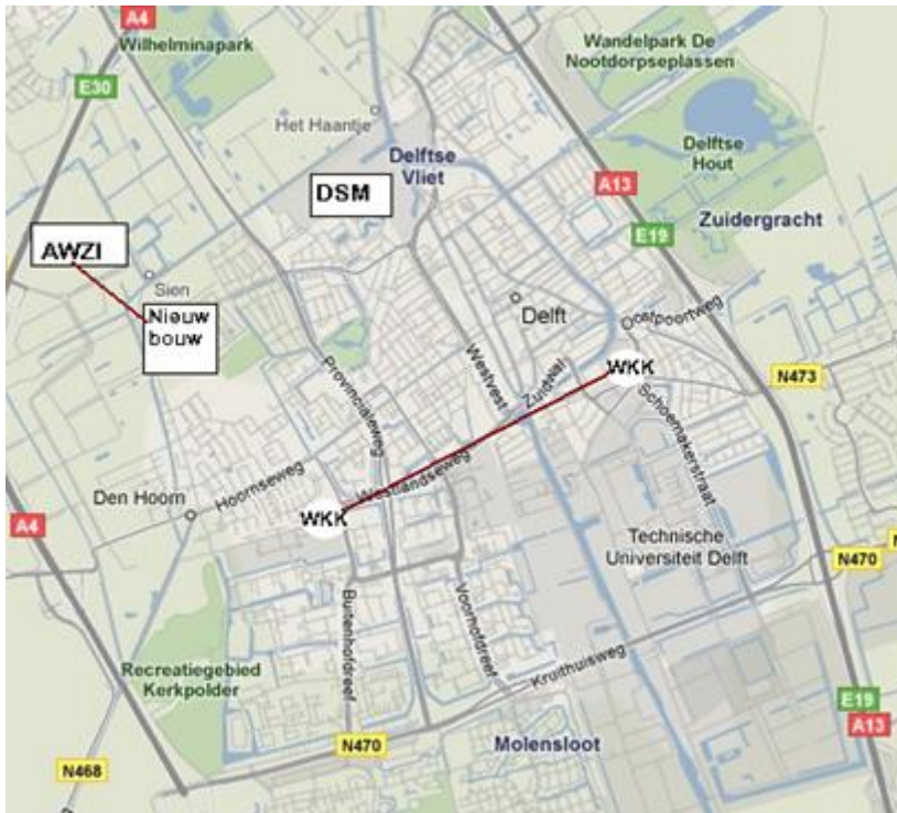
Figuur 2.2: Ligging WKK's en leidingen slechts ter indicatie; alleen in het oosten komen WKK's, in het westen wordt een piek- en back-up ketelhuis.
